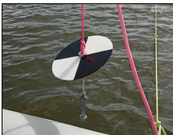
Figure 6 : Mesure de la transparence à l'aide du disque de Secchi © HYDRECO, 19/08/2025
