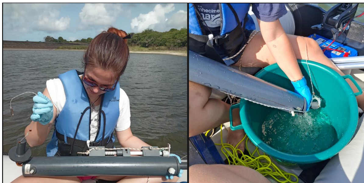
Figure 7 : Prélèvement à l'aide de la bouteille Niskin © HYDRECO, 2025
