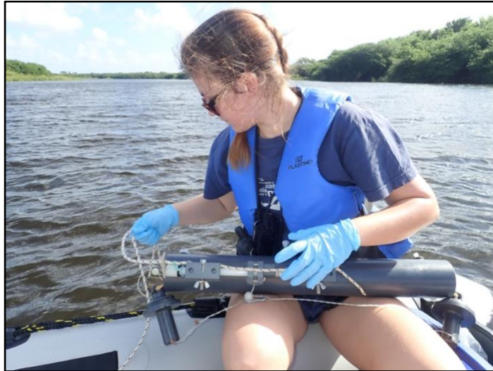
Figure 7 : Prélèvement à l'aide de la bouteille Niskin © HYDRECO, 26/11/2024
