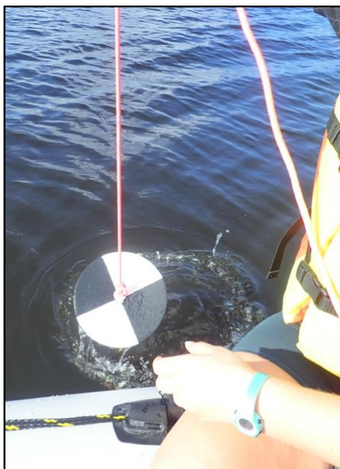
Figure 6 : Mesure de la transparence à l'aide du disque de Secchi © HYDRECO, 26/11/2024
