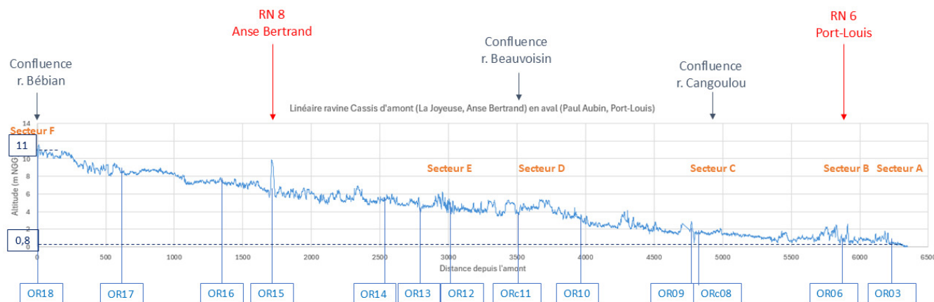
Figure 2: Profil altimétrique de la ravine Cassis.
