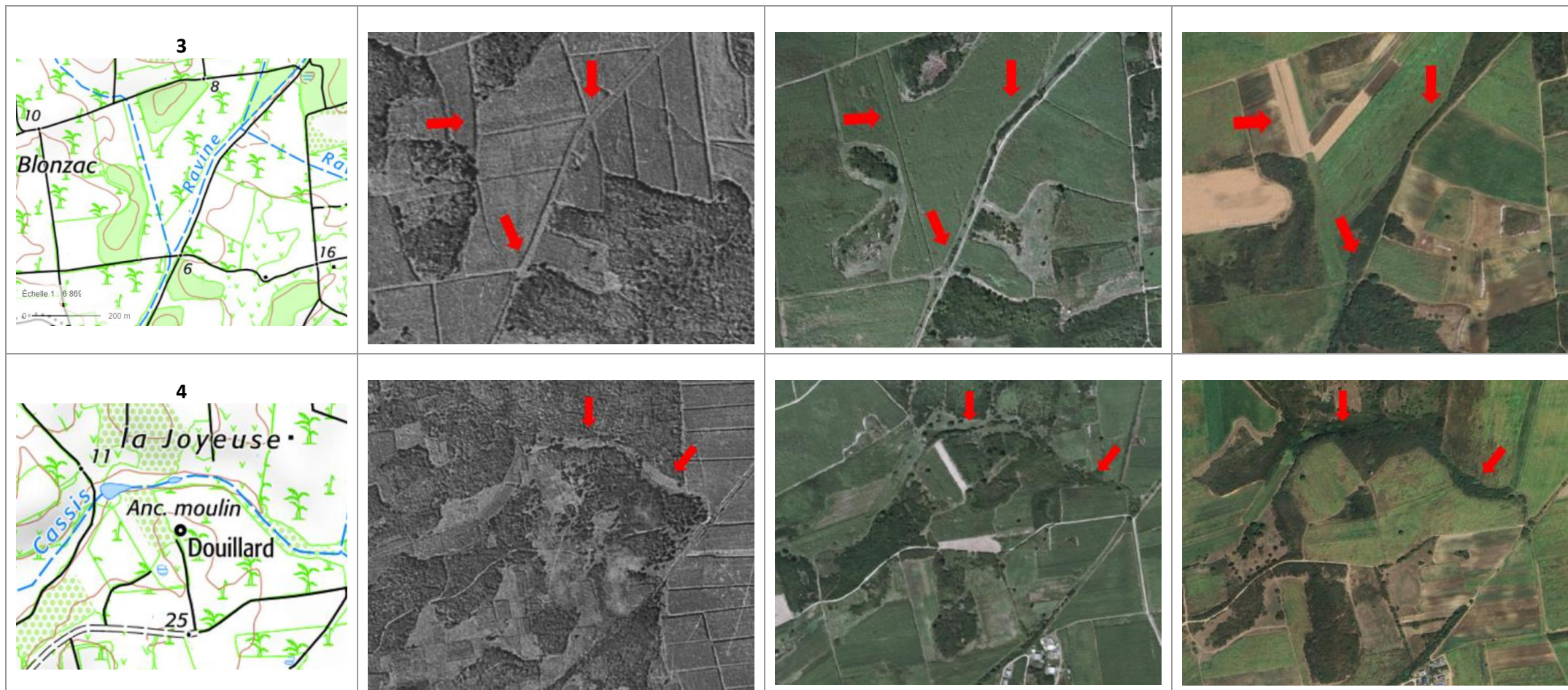
Figure 12 : Analyse cartographique de l'évolution de la ravine Cassis (source : IGN remonter le temps)
