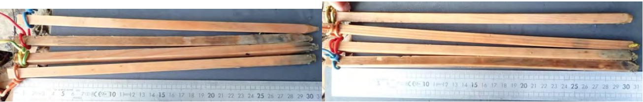
Figure 8 : Photographies des bâtonnets de colmatage après relève sur les radiers A et B (Fish-Pass)
