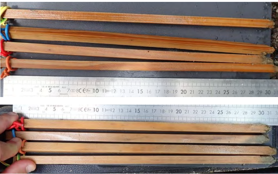
Figure 50 : Photographies des bâtonnets de colmatage après relève sur les radiers A et B (Fish-Pass)
