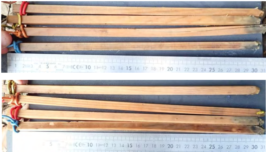
Figure 5 : Photographies des bâtonnets de colmatage après relève sur les radiers A et B (Fish-Pass)
