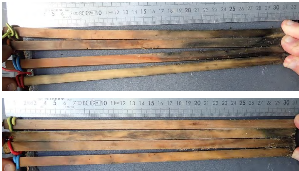
Figure 43 : Photographies des bâtonnets de colmatage après relève sur les radiers A et B (Fish-Pass)
