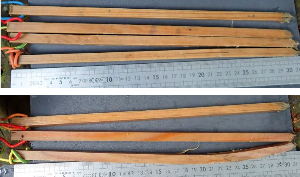
Figure 31 : Photographies des bâtonnets de colmatage après relève sur les radiers A et B (Fish-Pass)
