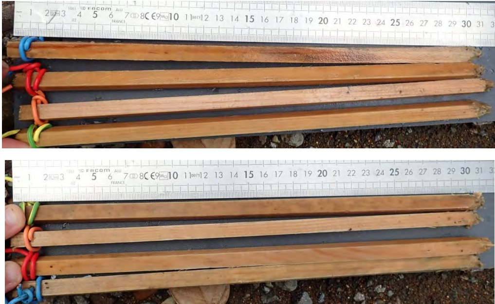
Figure 56 : Photographies des bâtonnets de colmatage après relève sur les radiers A et B (Fish-Pass)
