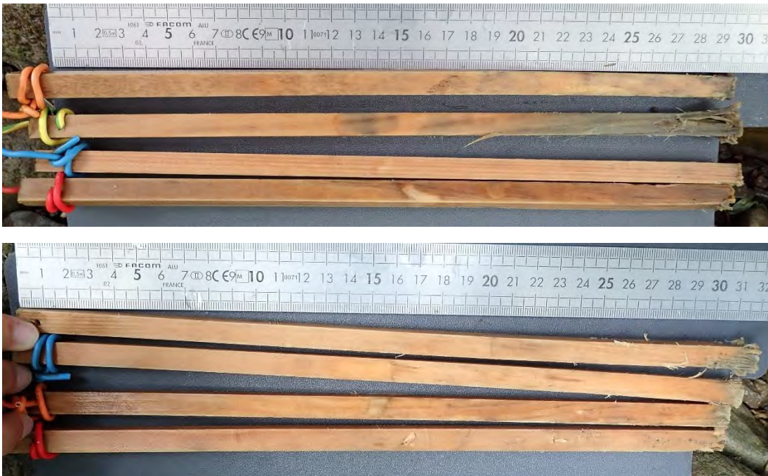
Figure 66 : Photographies des bâtonnets de colmatage après relève sur les radiers A et B (Fish-Pass)
